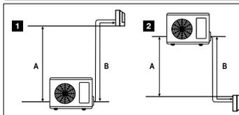
\*En el caso 2 (unidad exterior más alta) para desniveles superiores a 5~7m es necesario instalar una trampa de aceite en la tubería de gas cada 5~7m.
