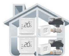
2. Dos zonas con 2 iT 700 y control de 2 válvulas motorizadas
